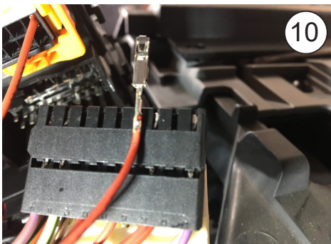
Retirar terminal com ferramenta específica
