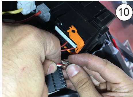
Aggraffare i cavi nel terminale in dotazione
